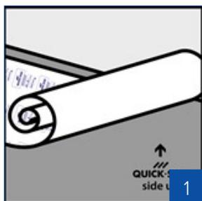
1. Déroulez la sous-couche sur le support avec le logo vers le haut. Le support doit être propre, sec et plat. Posez les bandes de sous-couche parallèlement au sens de pose de votre sol.
